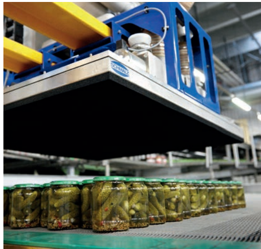
Jetzt: Per Knopfdruck wird eine komplette Palettenlage versetzt.
