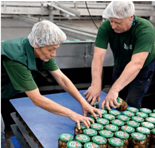
Früher: Umsetzen der Gläser in Handarbeit mit einseitiger Drehung des Oberkörpers; je tiefer die Palettenlage, desto gebückter die Haltung.
