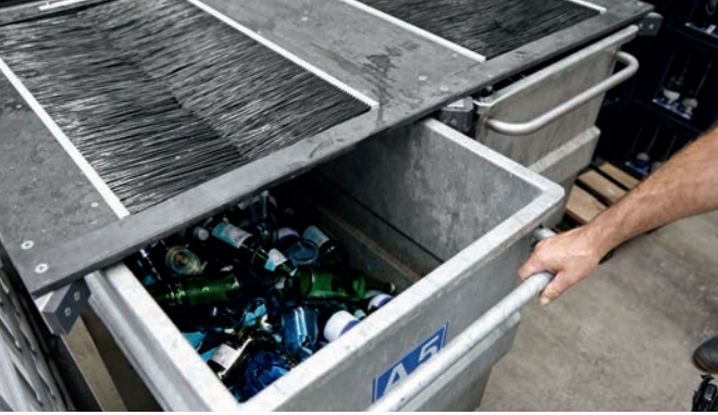
Bild 1 Erste Version der Bürstenabdeckung mit Gestell
