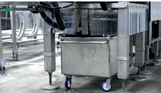
Bild 3 Scherbenwagen mit Bürstenabdeckung an maschineller Flaschenausschleusung
