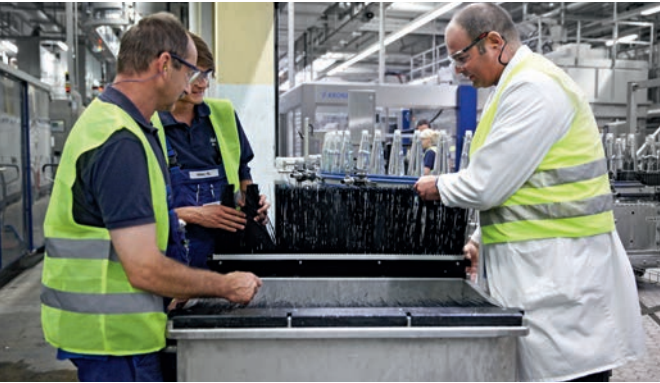
Bild 2 Neue, aufklappbare Bürstenabdeckung, fest montiert auf dem Scherbenwagen
