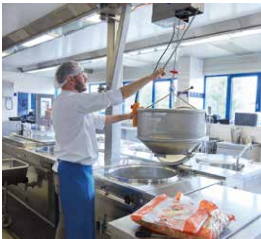
Die ungekochten Nudeln kommen mit dem Sieb in den Kochkessel. Das Sieb hängt an der elektrischen Hebevorrichtung.
