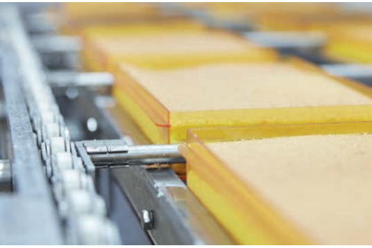
Die Mitnehmer sind jetzt mit Federklemmen in den Förderketten fixiert.
